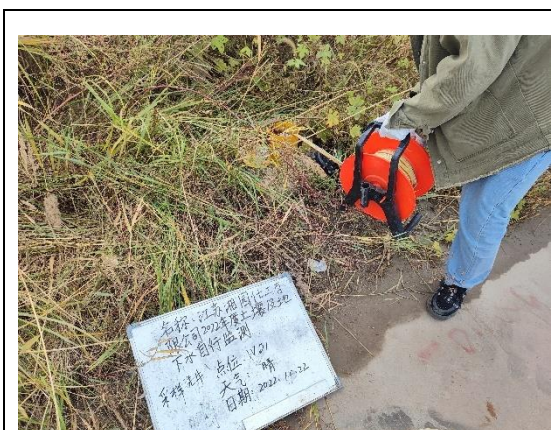
采样前洗井水位测量
