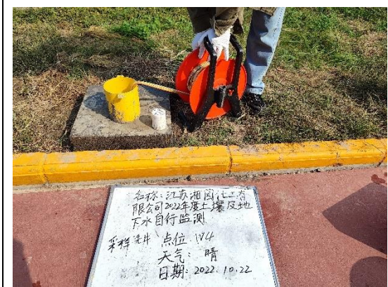
采样前洗井水位测量
