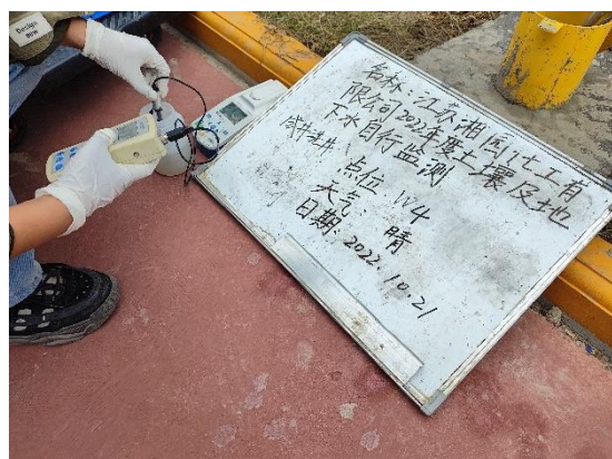
成井洗井出水现场检测
