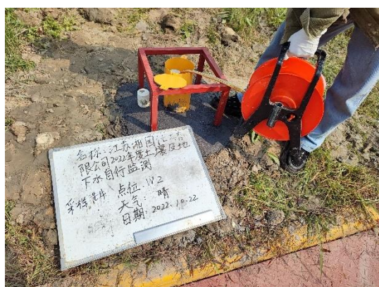
采样前洗井水位测量
