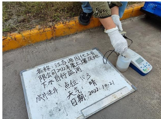
成井洗井出水现场检测
